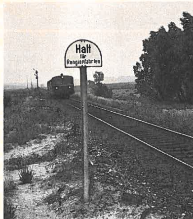
Rangierhalttafel Ra 10, die Tafel steht links vom Gleis. Über die Tafel hinaus darf nicht rangiert werden.
